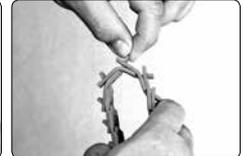
4. Achten Sie darauf, dass die Lasche wieder in die Endposition über dem Riemen zurückkehrt. Drehen Sie den Riemen um, sodass die Laschen sich auf der Innenseite befinden.
