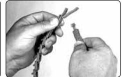
4. Ziehen Sie das Ende des Riemens durch die beiden Verbindungsglieder.
