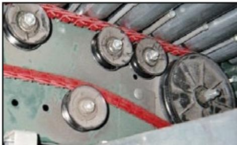
Com uma simples rotação do pulso para o encaixe simples e rápido dos elos, ganha uma solução permanente e segura para substituir a correia de borracha nos seus sistemas transportadores de roletes.
