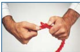
Lo speciale design a “collegamento rapido” permette un'installazione più facile e veloce, anche su trasmissioni nascoste o di difficile accesso. Le cinghie vengono composte facilmente alla lunghezza desiderata, e in pochi secondi e si possono avvolgere intorno alla trasmissione proprio come la catena di una bicicletta, senza dover smontare i componenti della trasmissione.
