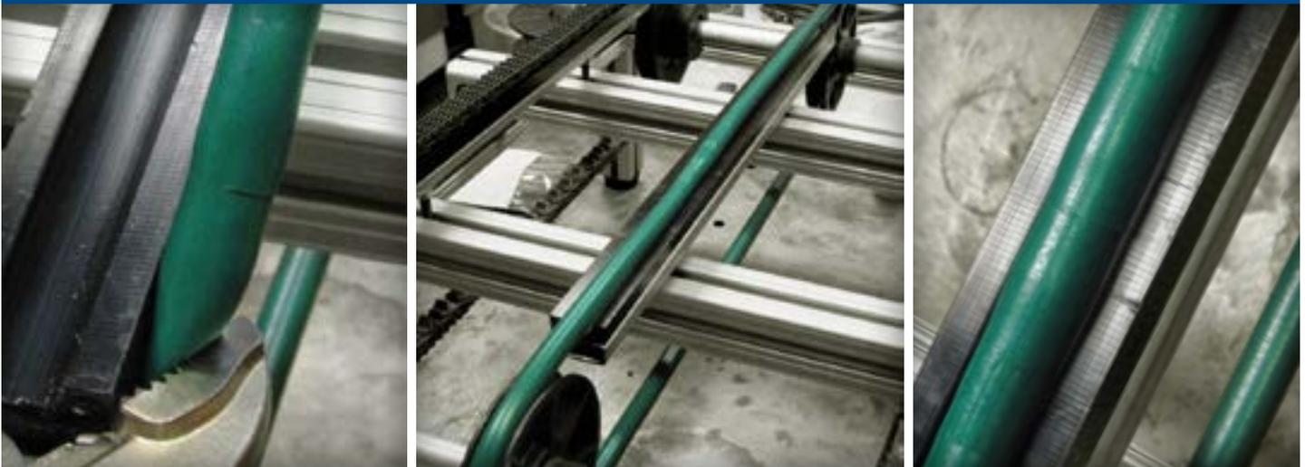
Retire la Llave Plana y Alicates de Bloqueo 1, luego rodar la correa sobre las poleas. Esto completa el proceso de instalación
