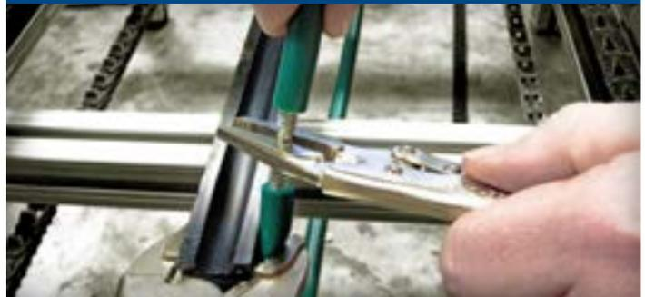
Posicionar el Conector contra el extremo hueco de la correa. Presione el extremo libre de la correa contra el Conector.
