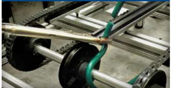
Dirigir la correa a lo largo del camino de la aplicación asegurándose rodear los ejes. Utilizando Alicates de bloqueo 1, fijar la correa al carril de guía o de otra parte de la estructura de tal manera que aproximadamente 1" de la correa sobresalga de la superficie.
