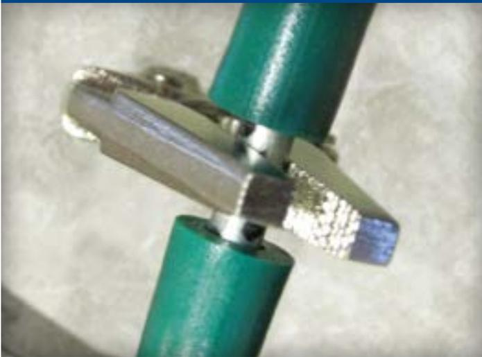
Mientras que pone presión sobre el extremo libre de la correa, comienza a enroscar suavemente el Conector en la correa hueca con los Alicates de Bloqueo 2. Continuar girando los Alicates de Bloqueo 2 hasta que el espacio se cierre contra la herramienta
